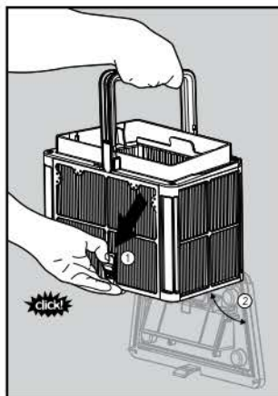
6.1.4 Откройте замок и откиньте нижнюю стенку корзины для удаления грязи.
